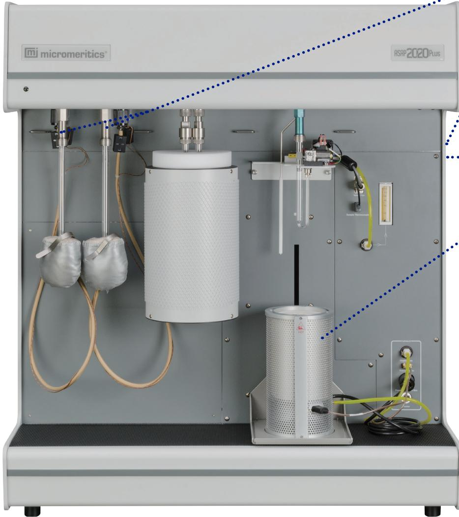
程序控制的双站脱气系统，能够在进行化学吸附分析的同时进行物理吸附样品的制备
