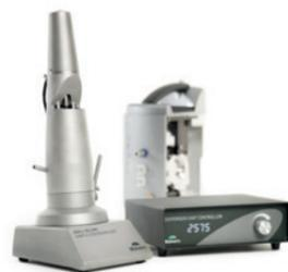
Hydro SM - 小容量手动进样器，适合需要在非水系分散剂中分散样品时使用。
