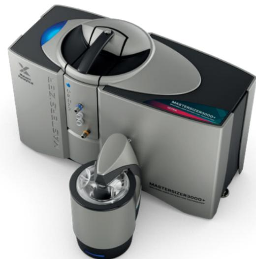
Hydro MV 是一款用于粒度分析的中等容量自动湿法进样器。专为需要较小样品粒度的应用而设计，适用于样品量少或者分散剂用量尽量少的测试需求。
