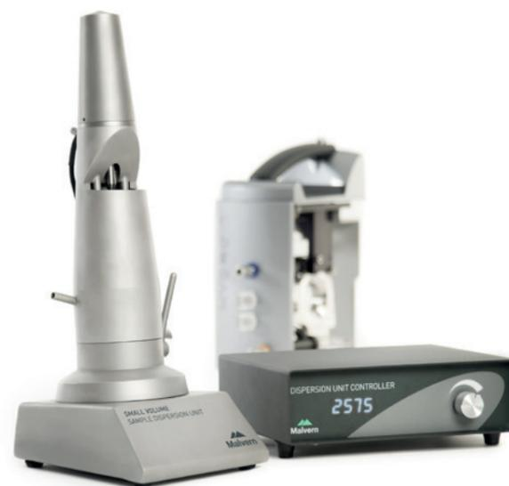
Hydro SM 是一款经济高效的湿法样品进样器，适用于有机相作为分散剂且溶剂用量要求尽量小的应用。
