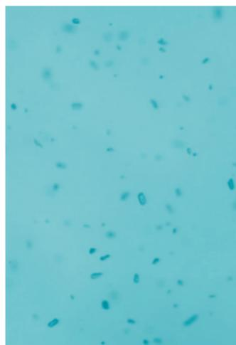
Hydro Insight 配件将 Vision Analytical 的动态成像专业技术与马尔文帕纳科的流动样品池技术相结合。当 Hydro Insight 与我们的 Mastersizer 3000 激光衍射系统配合使用时，可提供分散剂中颗粒和单个颗粒的实时图像，以及颗粒形状的量化数据。这有助于您更好地了解您的材料，更轻松地进行排查，并更快地开发颗粒粒度测量方法，最终提高您产品的性能。
