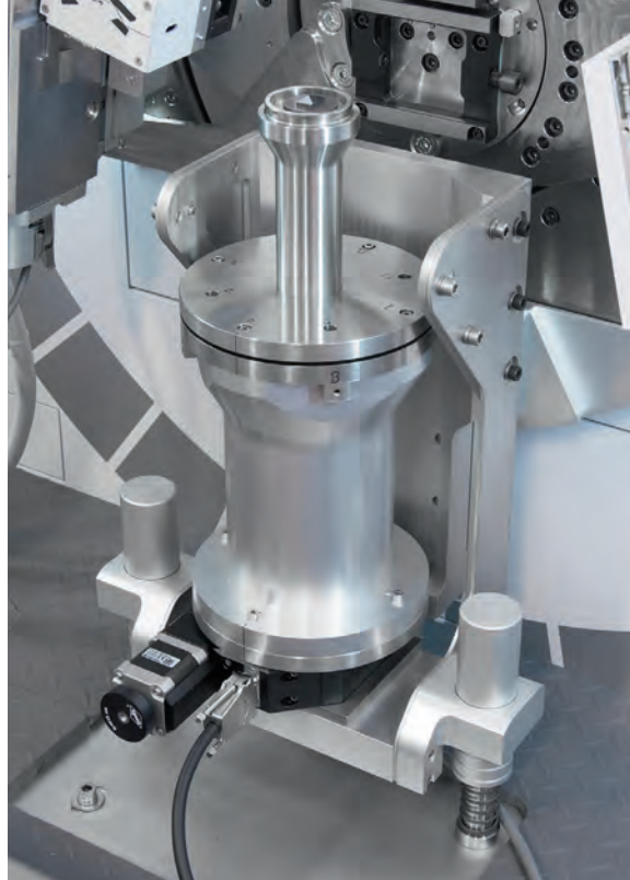
用于在切割和抛光前对大单晶进行定向的夹具
