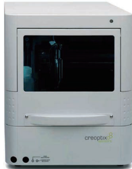
WAVE取样器: 容纳768个样品
