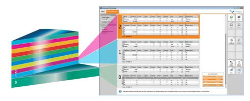
列表数据说明了 Zetium 和 Stratos 在分析不同类型涂层钢上的单层和/或多层涂层时的能力。各个样品的重复测量值也证明了仪器的稳定性和可实现的出色分析精度。这表明,含 Stratos
