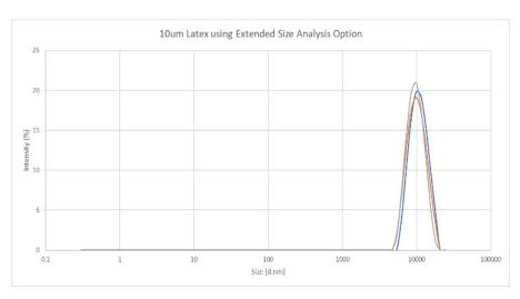
10μm乳胶球,采用可抛弃毛细管样品池,能够测量和显示 直径大于10μm的结果
