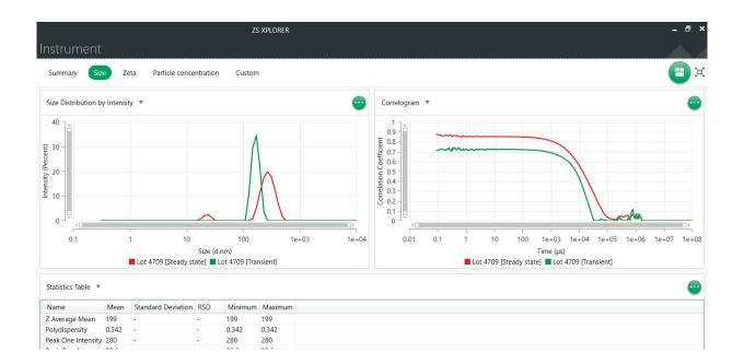
ZS Xplorer 采用一种名为"自适应相关"的新算法,此算法使用样品信息来确定测量时间的长短,并且持续收集数据,直到最终结果保持一致为止。
