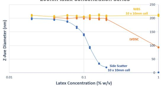
200nm乳胶球,采用可抛弃型微量毛细管粒度样品池,样品浓度上限显著提升
