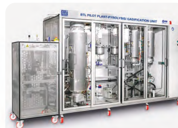
生物质固体进料热解 / 气化装置 —— 制取合成液态产物
